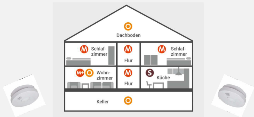
Rauchmelder-Installation in einem Einfamilienhaus
