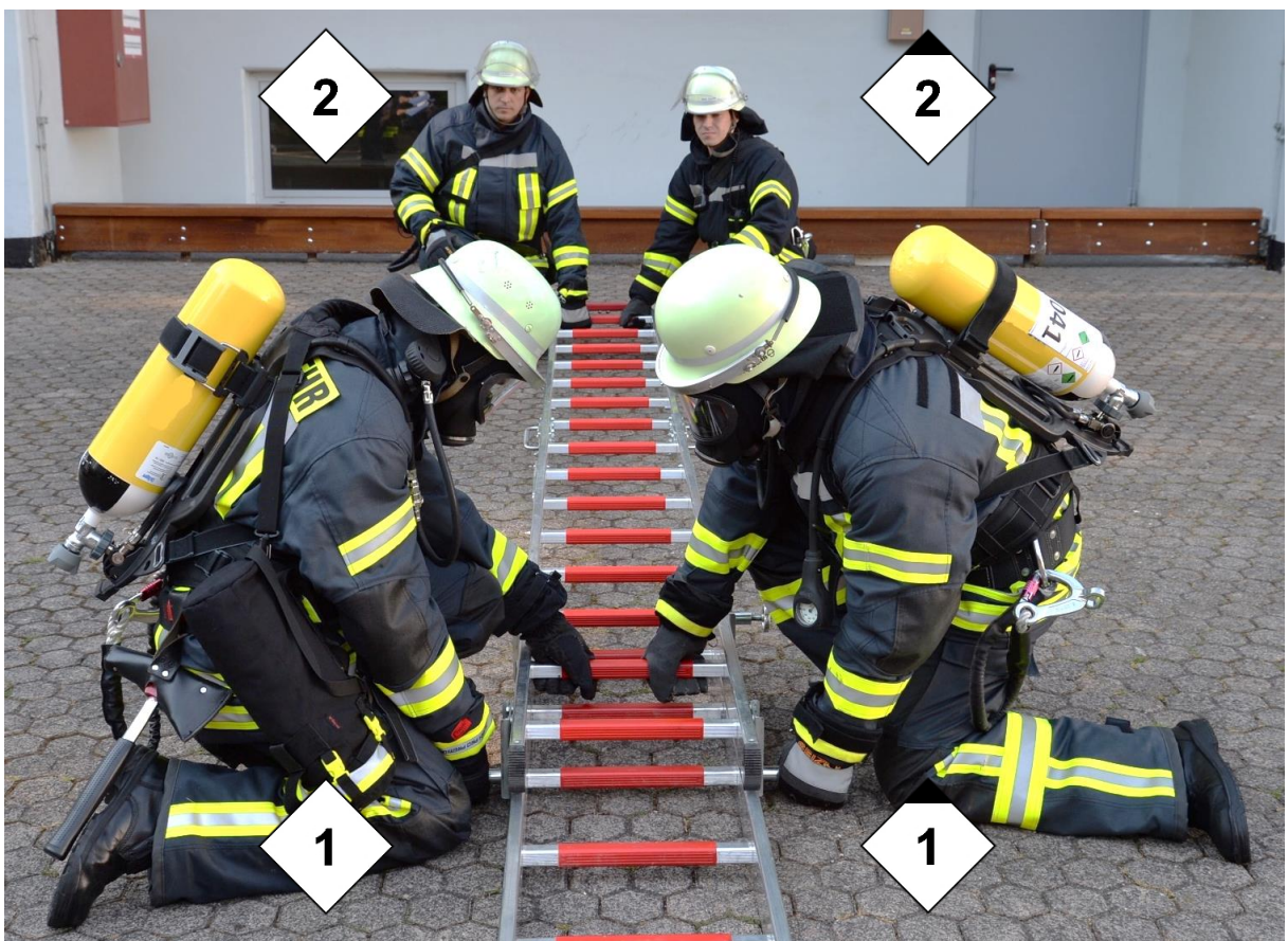
Abbildung 41: Verbinden der Multifunktionsleitern
