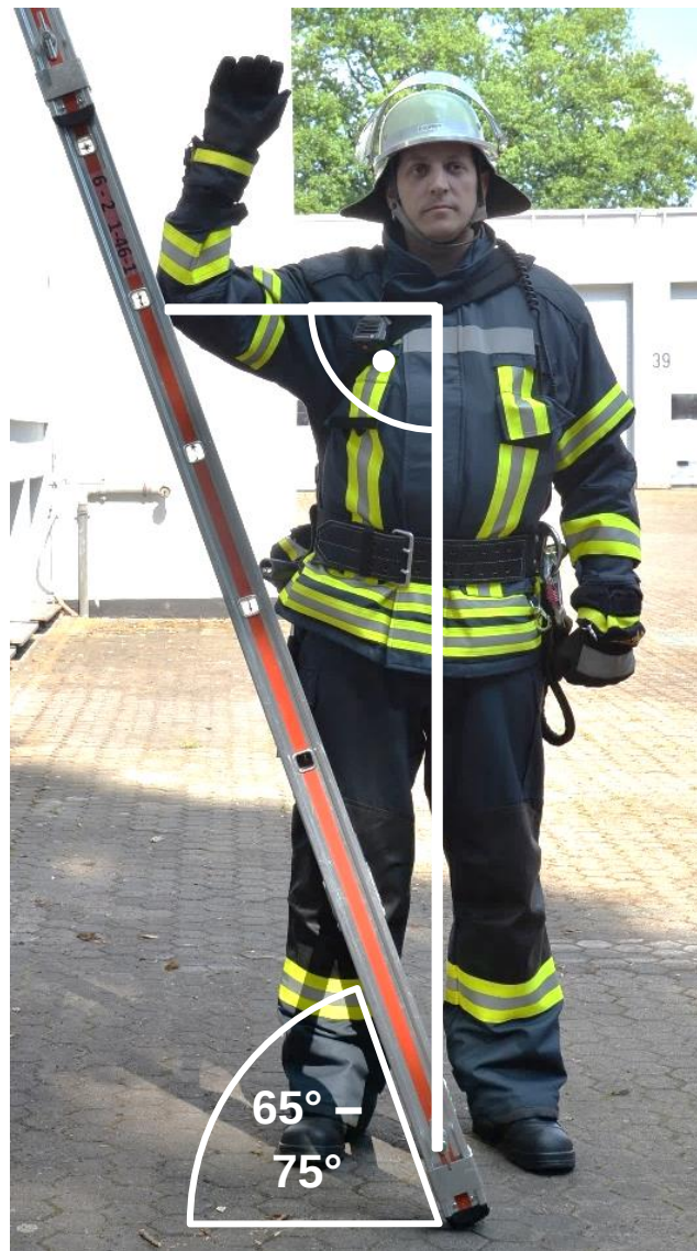
Abbildung 2: Überprüfen des Anstellwinkels
