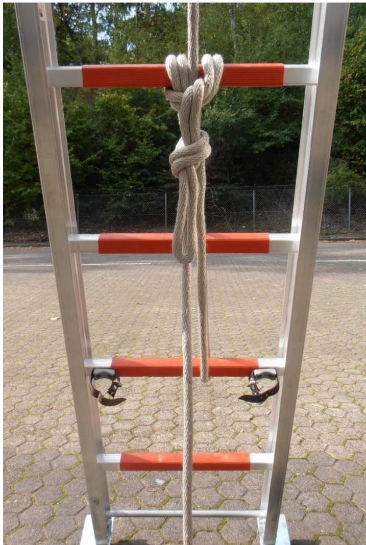
Abbildung 24: Sichern des Zugseils mit Mastwurf und Spierenstich
