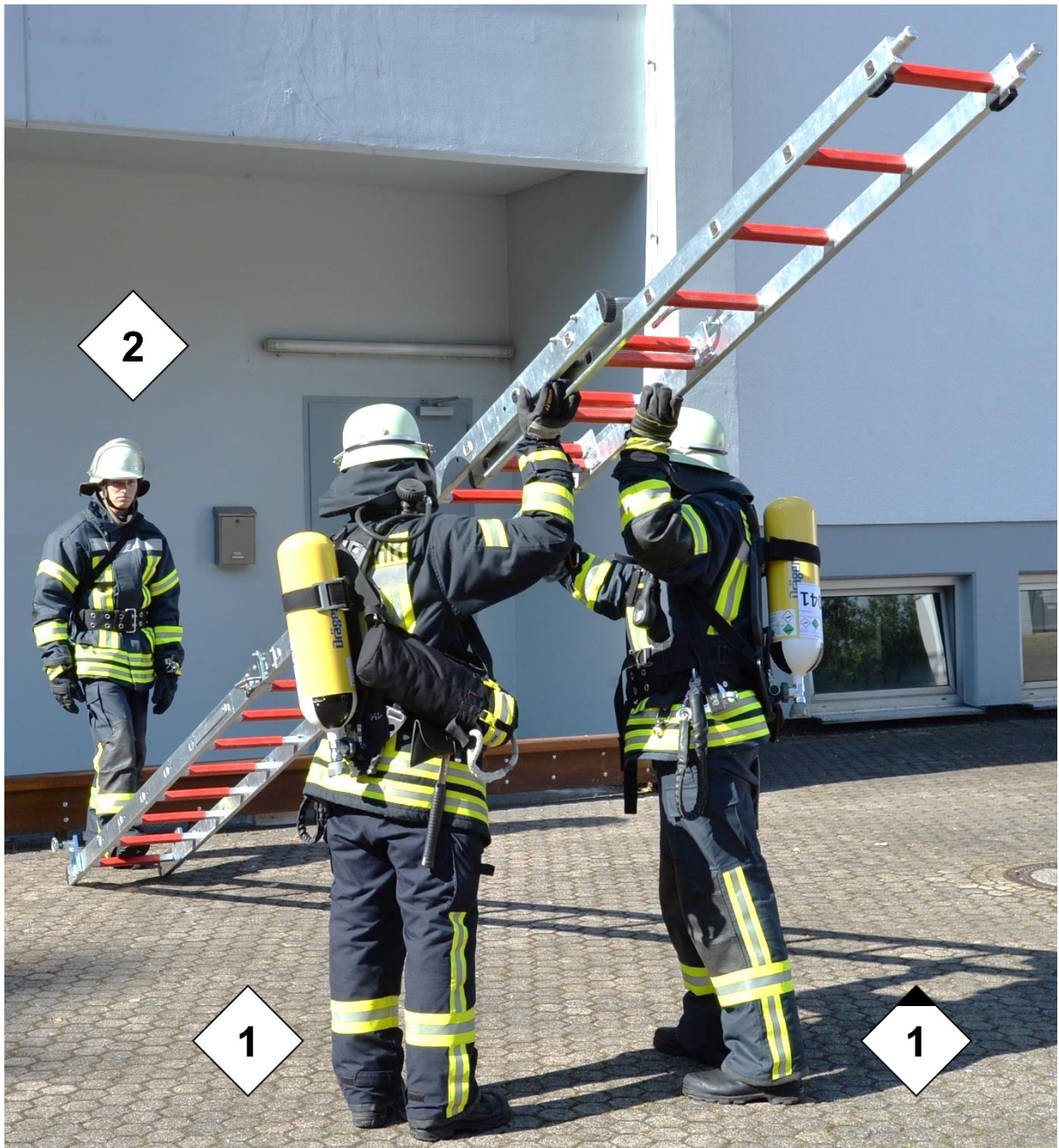
Abbildung 36: Aufrichten der Multifunktionsleiter
